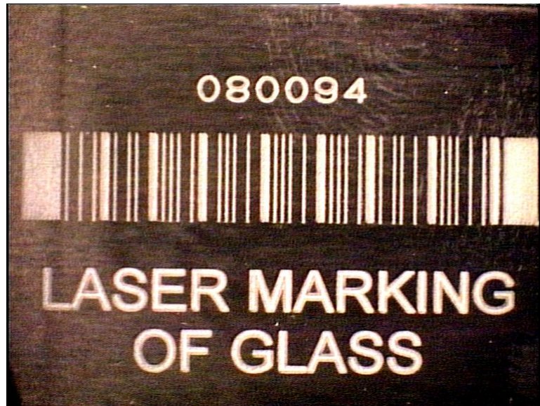
Figure 2.19: Deposited ceramics on glass [Q-switched Nd:YAG] [source: Institut für Fügetechnik und Werkstoffprüfung (IFW) ]
